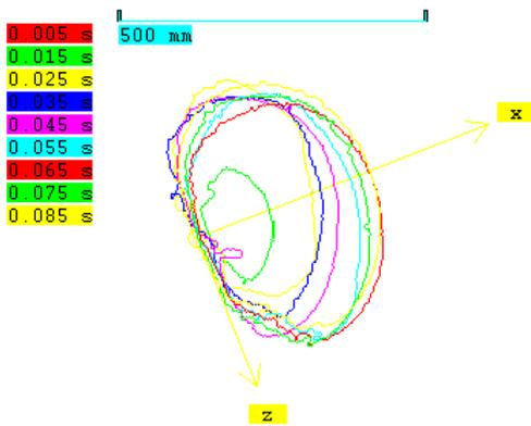
Das Auswerteprogramm **eXtra MovBag** ermöglicht die automatische Erfassung von Airbagumrisslinien als Konturgraphen =  $f(t)$ .
